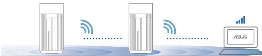
**NOTAS:** Para minimizar las interferencias, mantenga los routers alejados de dispositivos como teléfonos inalámbricos, dispositivos Bluetooth y hornos de microondas.
